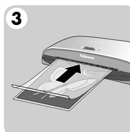
Vložte vrecko, najprv zlepenu hranou, do vstupu laminátora. Držte vrecko rovno a použite vodiacu hranu na jeho vycentrovanie.
