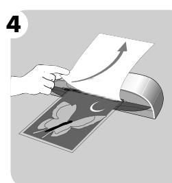
Vložte laminovací fólie uzavřenou stranou do vstupní štěrbiny do laminátoru. Držte laminovací fólie rovně a pomocí postranního vodítka ji vycentrujte. Pokračujte ve odtrhávání ochranné fólie.
