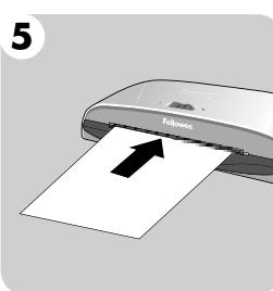
Než laminátor vypnete, nechte strojem projít prázdnou čisticí fólií/nosič, a stroj tak vyčistěte.
