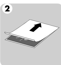
Položte dokument doprostřed průhledné fólie, okrajem k uzavřené straně; položu dokumentu **nelze** po zalamování již upravovat.
