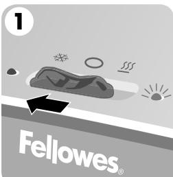
Posuňte tlačidlo napájania na studené nastavenie a počkajte na zelenú kontrolku prípravnosti.
