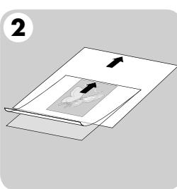
Vložte dokument do laminovací fólie a zasuňte jej k uzavřené straně. Abyste zabránili uvíznutí dokumentu, použijte v případě, že je tento dokument menší než laminovací fólie, nosič laminovací obálky.
