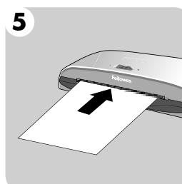
Pred vypnutím laminátora, vložte prázdny čistiaci/nosičový list do stroja na výčistenie stroja.
