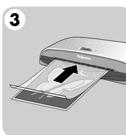
Vložte laminovací fólie uzavřenou stranou do vstupní štěrbiny do laminátoru. Držte laminovací fólie rovně a pomocí postranního vodítka ji vycentrujte.
