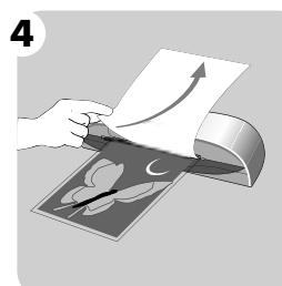
Vložte vrecko, najprv zlepenu hranou, do vstupu laminátora. Držte vrecko rovno a použite vodiacu hranu na jeho vycentrovanie. Pokračujte v odstránení ochrannej strany.
